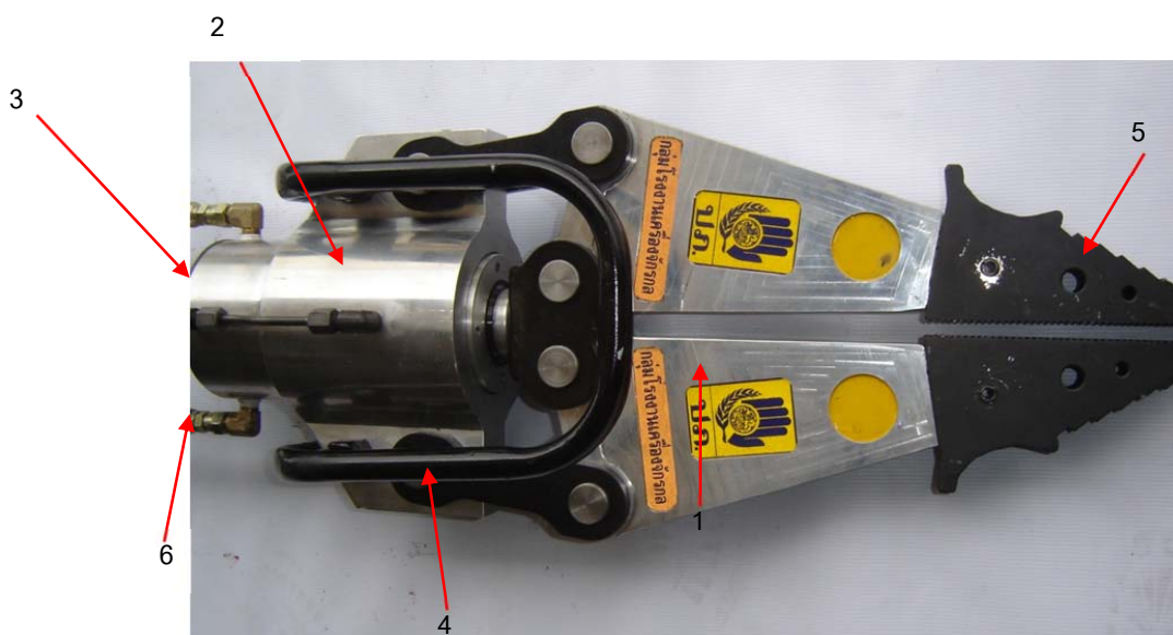
รายละเอียดเครื่องถ่าง(Spreader)
